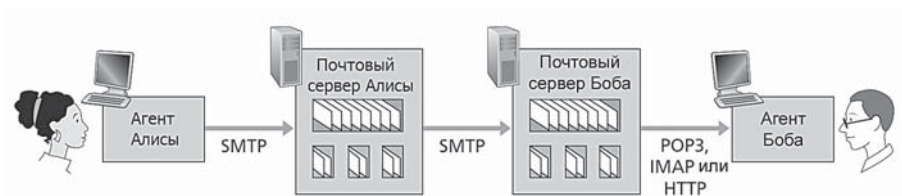
Рис. 2.18. Протоколы электронной почты и их взаимодействующие компоненты
