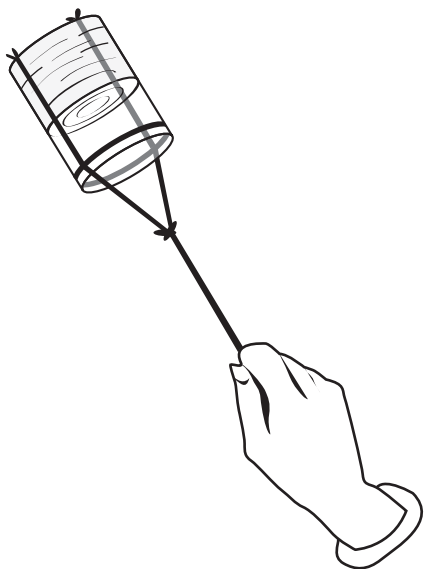
Рис. 29. Вода не выливается из стакана, если заставить его достаточно быстро кружиться.
