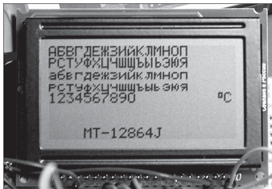
Рис. 20.11. Результат выполнения тестовой программы для дисплея MT-12864J
