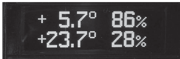
Рис. 20.17. Дисплей метеостанции с демонстрацией данных двух датчиков на дисплее WEG10032
