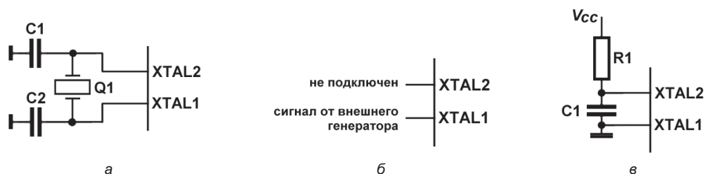
Рис. 22.2. Способы тактирования МК AVR с использованием: а — кварцевого резонатора; б — внешнего генератора; в — RC-цепочки
