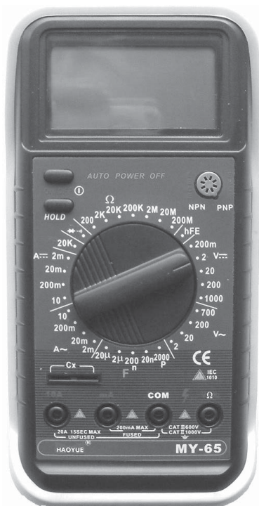
Рис. 2.1. Типовой мультиметр с дополнительной функцией измерения емкости
