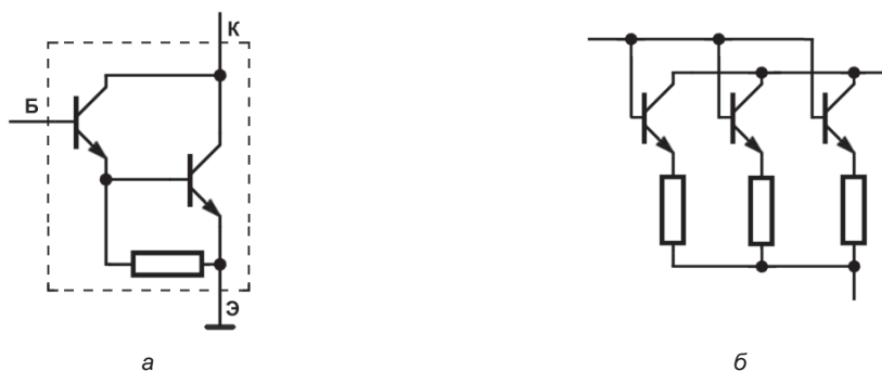
Рис. 6.5. Другие схемы подключения: а — транзистор Дарлингтона; б — параллельное включение транзисторов
