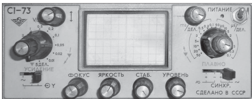
Рис. 2.5. Панель малогабаритного аналогового осциллографа С1-73
